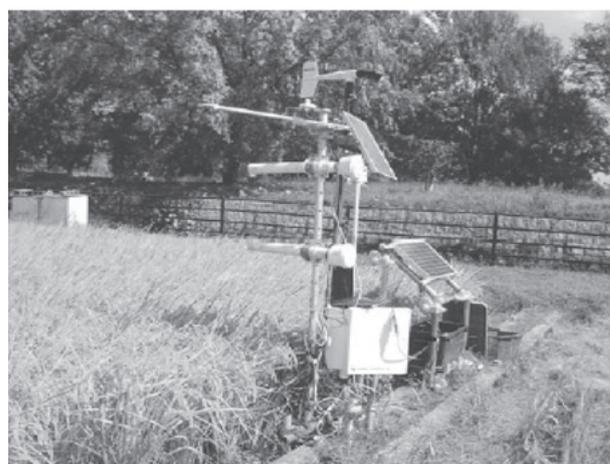
Fig.1 実蒸発散量測定システム
