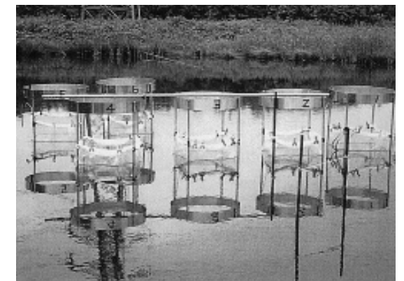
小型隔離水界 - 円筒型 (直径 1 m、深さ 4 m) ステンレスの骨組につけたポリエチレンのバッグ。底は底泥に開口している。メソコスムスとして生態系への影響の研究に用いる。
