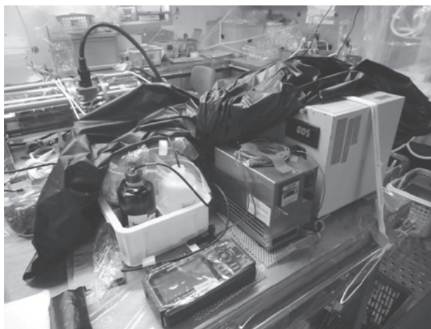
共同研究者の東大気海洋研：小畑元准教授開発の化学発光式Fe(II)分析装置です。
